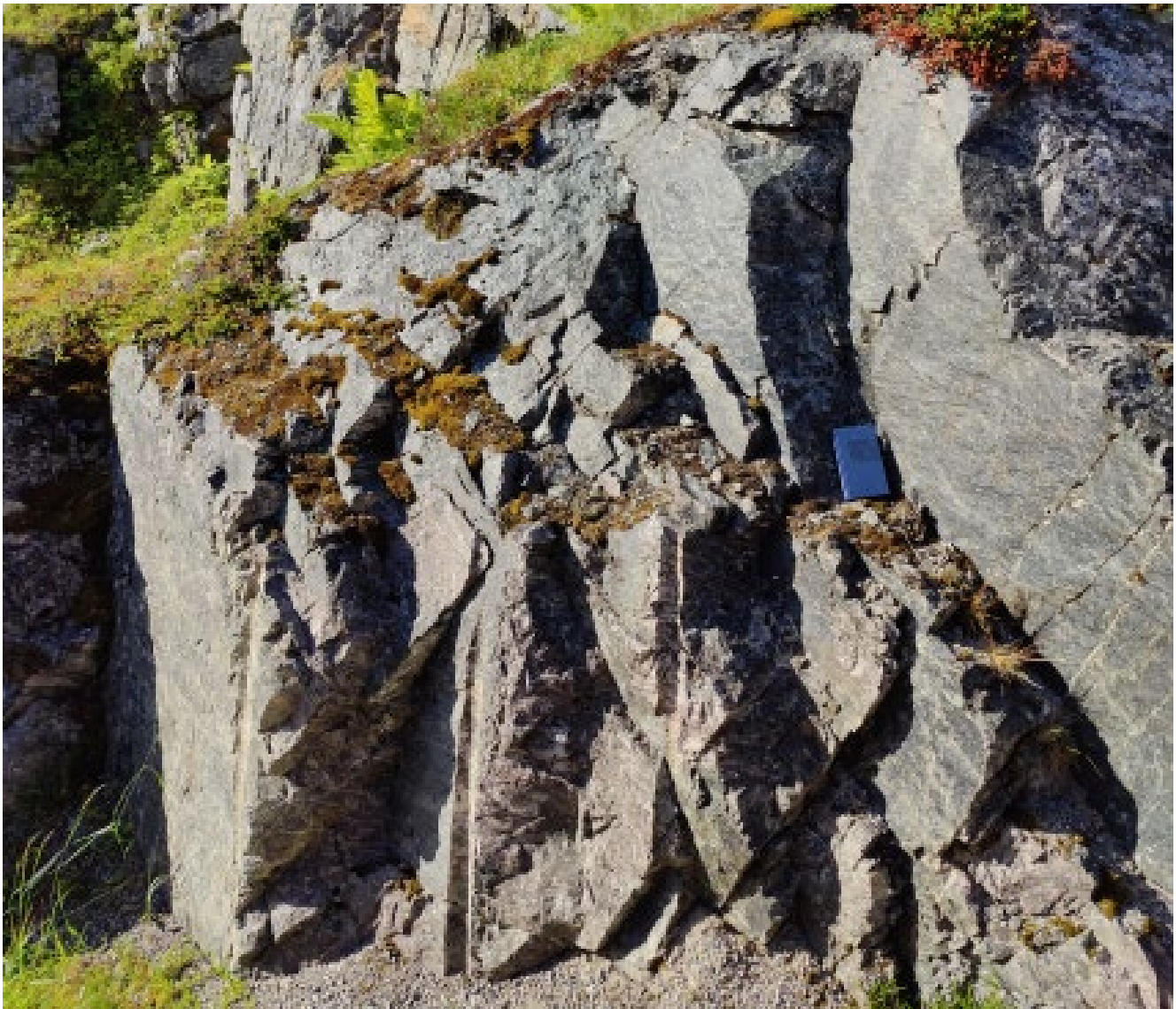
Figur 2-6: Varierende sprekkeavstand. 8-20 cm og 50-120 cm
