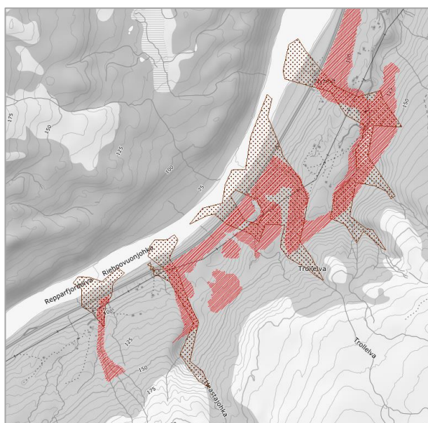
Figur 2. NVEs aktsomhetskart for jord- og flomskred (brune prikker) sammenstilt med skredfarekartlegging til reguleringsplan for Øvre Skaidilia (rød skraver) for avklaring av reell fare. For ordens skyld opplyses det om at planområdet, og dermed også skredfaresonene i rødt, stopper ved hovedveien. Kartutsnittet gir derfor ikke et komplett bilde av skredfaren.
